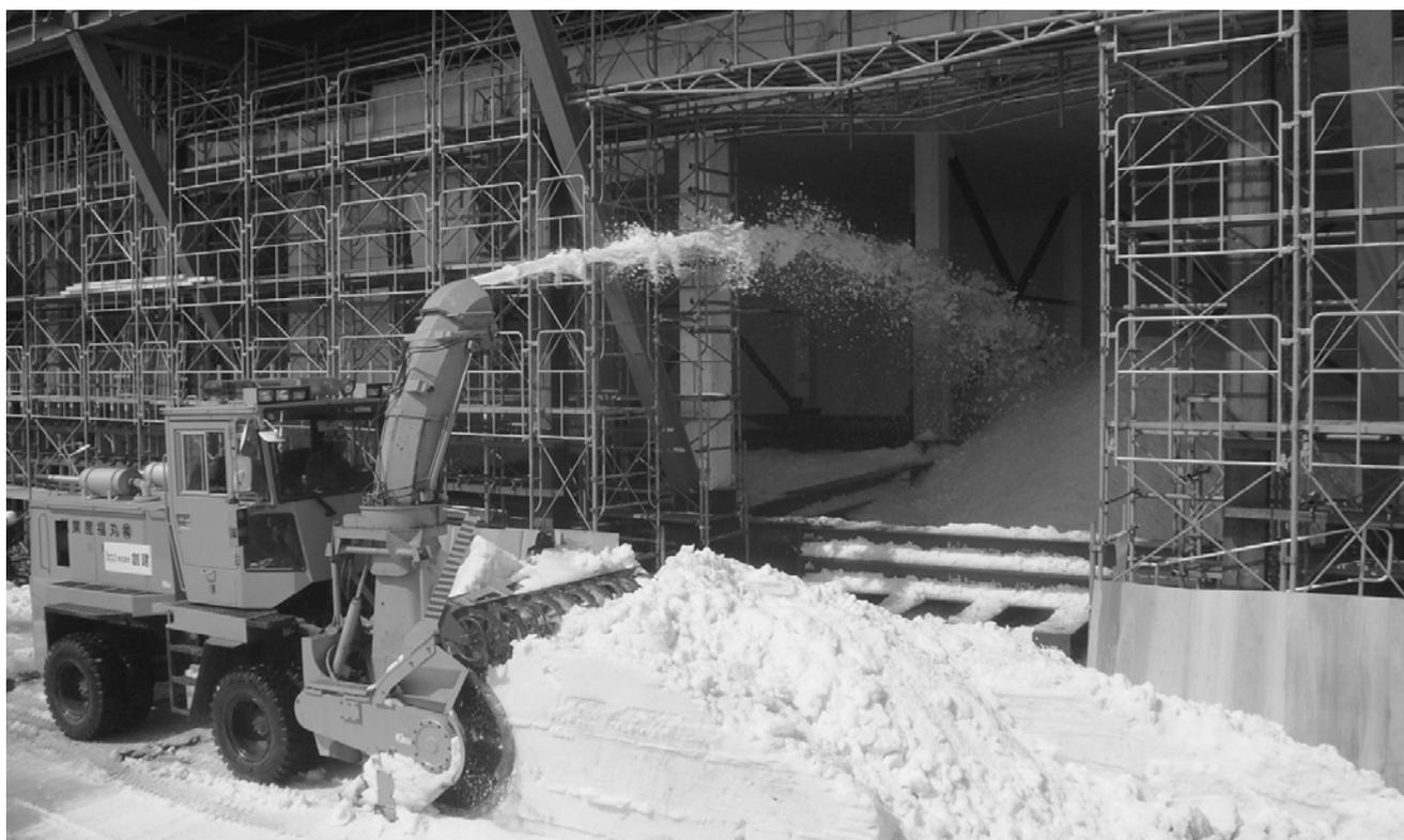
写真 - 5 ロータリー除雪車による雪の投入
