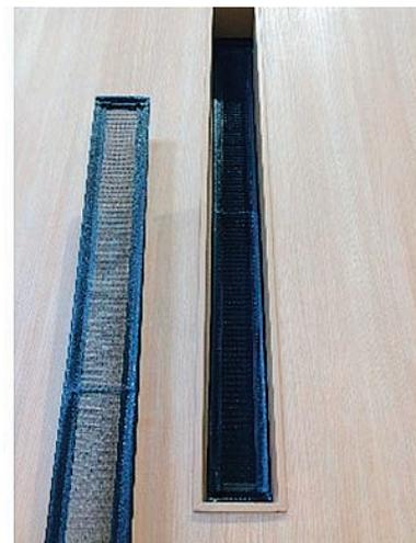
写真-11 間仕切り壁チャンバと壁面レタンフィルタ
